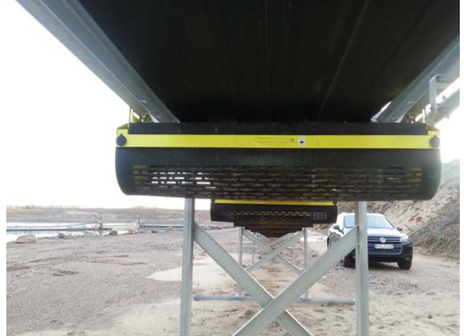
Bild 9: Leicht zu reinigender Schutzkorb
