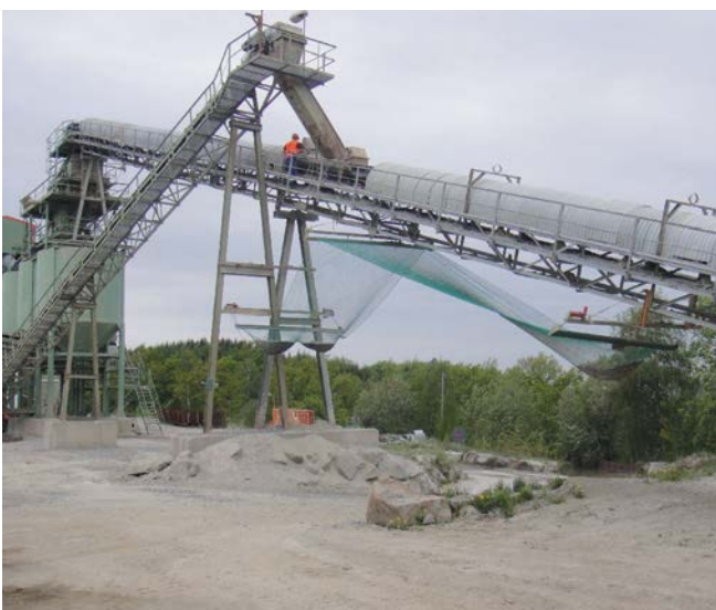
Bild 15: Band unterfangen mit Netzen
