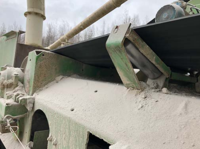
Bild 7: Füllstücke an der Antriebsstrommel und an der letzten Tragrolle (Änderung der Gurtmuldung)
