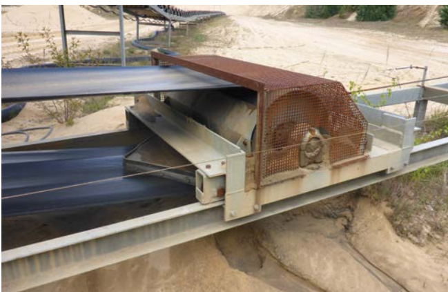
Bild 4: Umlenktrummel mit einer Kombination aus Füllstück und Pflugabstreifer
