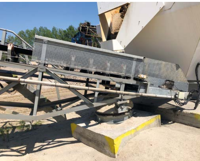
Bild 8: Schutzgitter an überbauten Rollen an der Bandaufgabe
