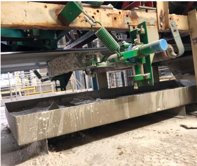
Bild 17: Mit einer Feder vorgespannter Untergrurtabstreifer mit Materialauffangwanne
