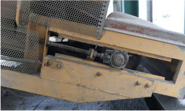
Bild 3: Schutzgitter an Umlenktrummel – Spannschrauben zur Einstellung von Gurtspannung und Geradeauslauf sind frei erreichbar
