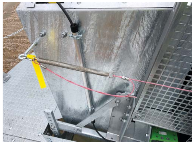
Bild 10 a: Gespannte Feder an den festen Enden der Reißleine
